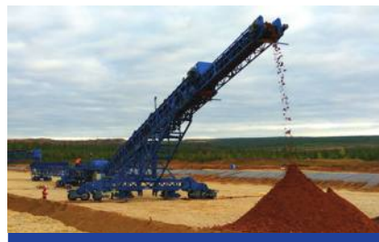
Конвейер телескопический выдвижной (радиальный перегружатель)
