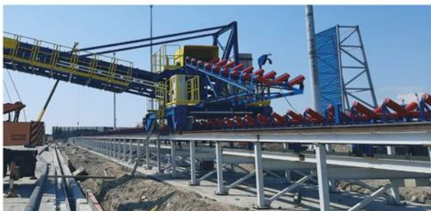
Перегрузочное устройство с конвейера на судопогрузочную машину
