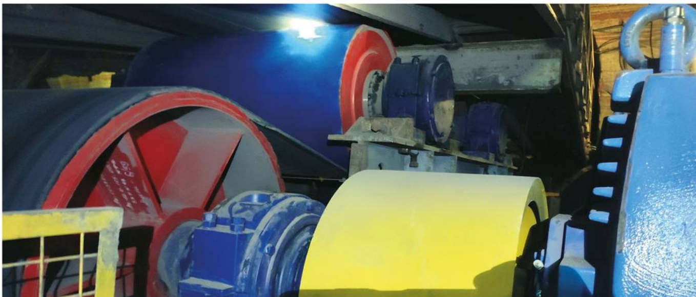
Не приводные барабаны, изготовленные по немецким технологиям в АО «НПО «Аконит» в 2022 году.
